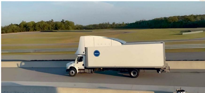
тянуть транспортное средство вверх. В результате использования системы Eco Eolic Top System сокращается расход топлива, а также снижается нагрузка на дорожную поверхность, что снижает ее износ.
